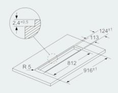
Für den flächenbündigen Einbau in Stein- und Granitarbeitsplatten
